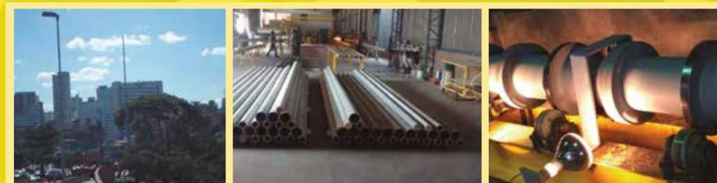
O sistema de centrifugação é a inovação tecnológica para a produção de postes em fibra de vidro. O processo consiste em moldar as malhas, resinas e aditivos, centrifugando mecanicamente sem interferência manual, eliminando a presença de bolhas de ar.
